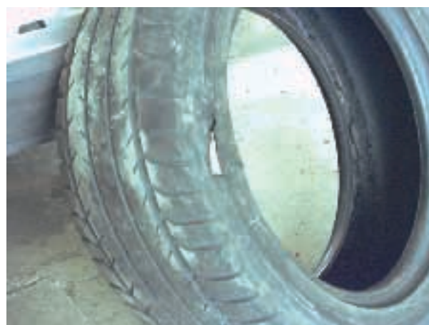
Sopra: pneumatico che ha camminato a piatto dopo espulsione della valvola. Vista dell'esterno ed interno.
