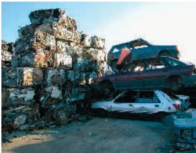
Area dove viene eseguita la riduzione volumetrica delle carcasse auto bonificate mediante pressatura.
