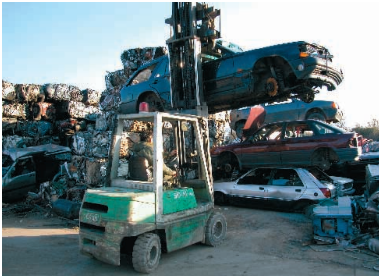
Movimentazione e collocazione di carcasse auto bonificate in apposita area finalizzata alla riduzione volumetrica mediante pressatura.
