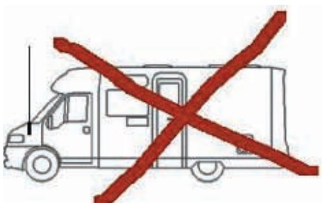
*Analogamente al caso precedente sono da scartare i fissaggi dell'antenna sui fianchi del cofano motore o sul paraurti anteriore.*
