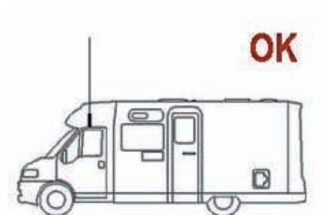
*Quando non si riesca a fare diversamente si opererà per un compromesso tecnico, cercando appoggi, per la base dell'antenna, nella parte alta della cabina o sui supporti degli specchi retrovisori.*
