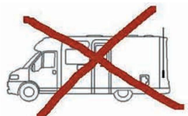
*Il posizionamento dell'antenna nella parte posteriore bassa, zona paraurti o similari non è idonea: tutta la rimanente struttura del mezzo schermo ed altera il funzionamento, in modo particolare verso la parte anteriore.*
