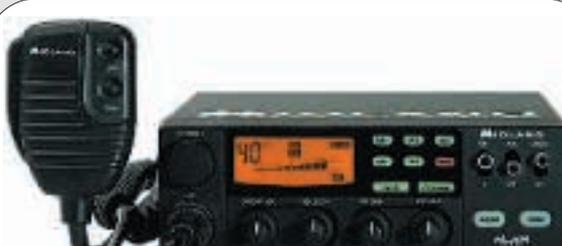
Nuovo apparato della CTE INTERNATIONAL, operante sui 40 canali della banda cittadina (CB), con l'importante caratteristica di essere completamente controllato da un microprocessore.
