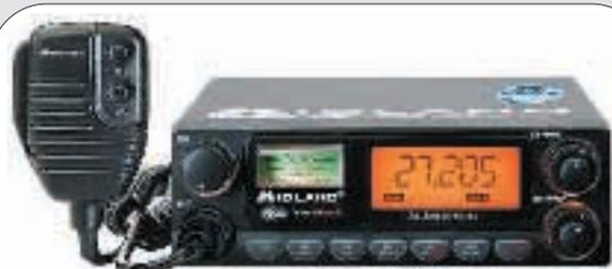
È un ricetrasmittente operante sui 40 canali della banda CB; utilizza una circuiteria allo stato solido, i più robusti circuiti stampati, i componenti e le tecnologie più avanzate per darvi un apparato della massima qualità, che vi garantisca le migliori prestazioni sempre ed ovunque.
