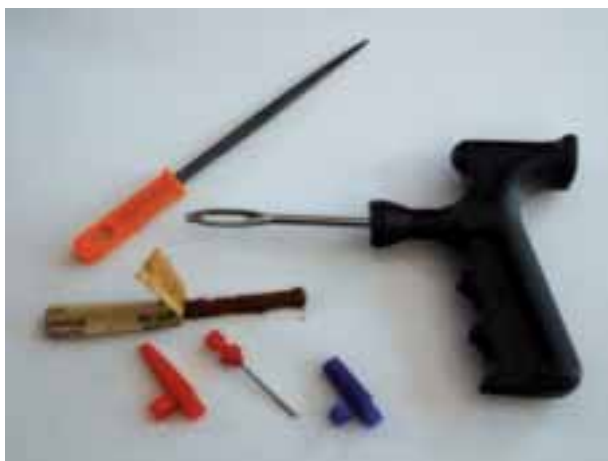
Gli "arnesi" in dotazione, una limetta, tre adattatori per palloni, un cordoncino che dovrebbe essere inserito nel foro del pneumatico per mezzo dell'asola presente nell'accessorio con manico a destra
