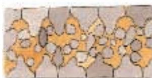
Sezione di una muratura a secco. (disegni cooperativa Ichnussa)
