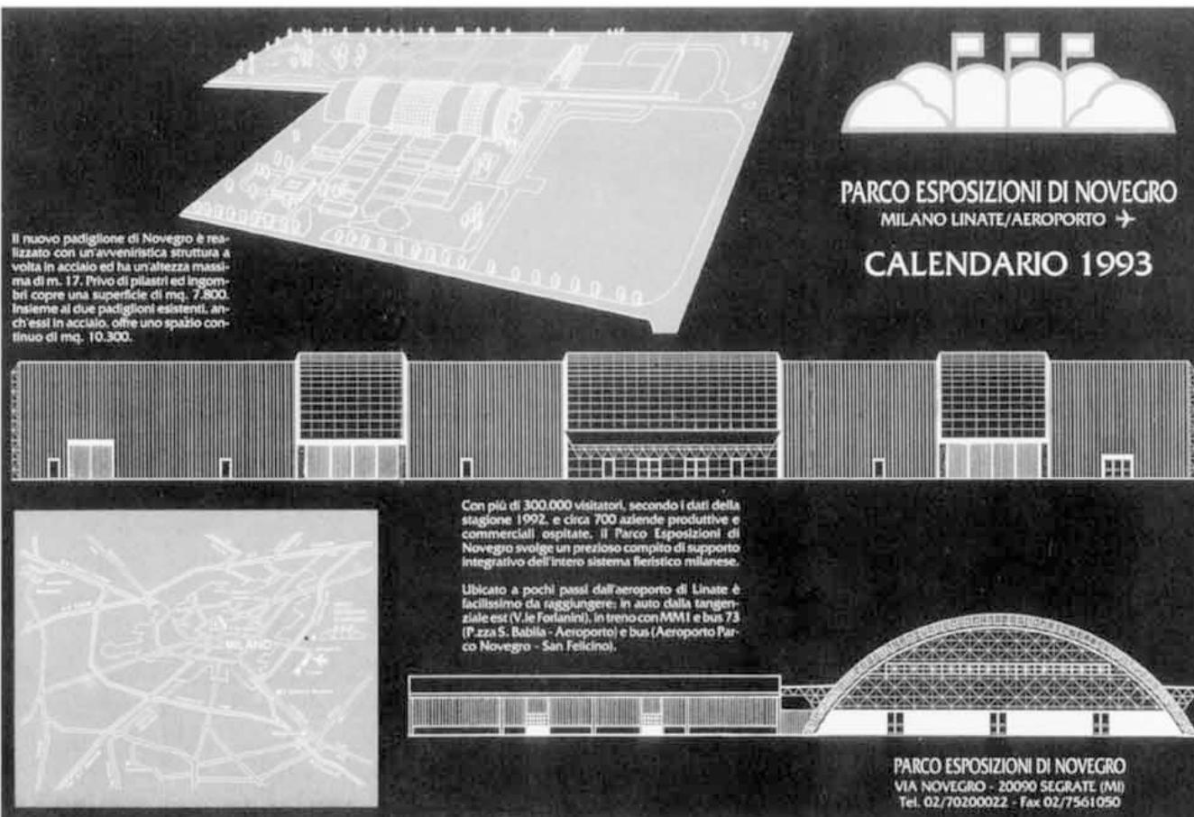
Il nuovo padiglione di Novogro è realizzato con un'avveniristica struttura a volta in acciaio ed ha un'altezza massima di m. 17. Privo di pilastri ed ingombri copre una superficie di mq. 7.800. Insieme ai due padiglioni esistenti, anch'essi in acciaio, offre uno spazio continuo di mq. 10.300.
