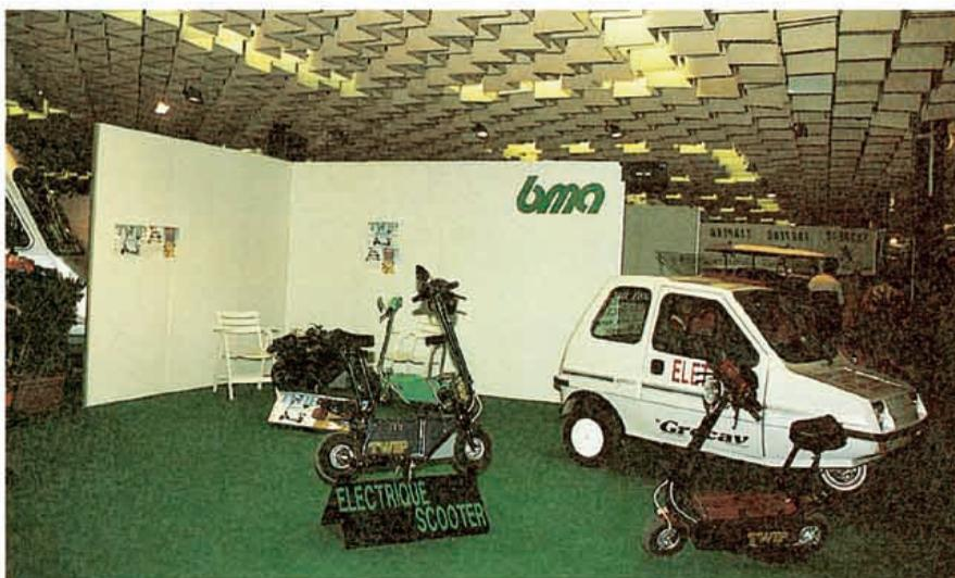
**Stand BMA** auto a trazione elettrica da guidare senza patente e il Twip scooter a trazione elettrica che presenta la particolarità di occupare poco spazio (trova posto in un bagagliaio di una vettura di media grandezza) e di poter ricaricare le batterie con la normale rete domestica oppure con l'impianto dello stesso camper o auto.
