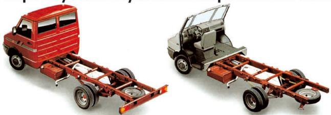
ROBUSTI: dispongono strutturalmente di un vero telaio "da camion" a longheroni che garantisce la massima affidabilità. Concepiti come mezzi da trasporto consentono qualsiasi allestimento e sono dotati di trazioni 4×2 o 4×4 per soddisfare qualsiasi esigenza di utilizzazione.
