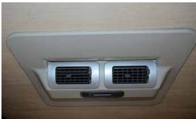
Il gruppo centralina-bocchette di aereazione del condizionatore all'interno dell'autocaravan
